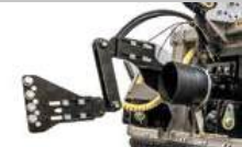
Dispositivo de autoalinhamento estilo W entre o cardan e a caixa de engrenagens da tomada de força (PTO)
