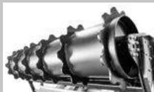
**Rolo de apoio hidráulico ou rolo largo hidráulico**
