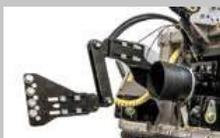
Dispositivo de autoalinhamento estilo W entre o cardan e a caixa de engrenagens da tomada de força (PTO)
