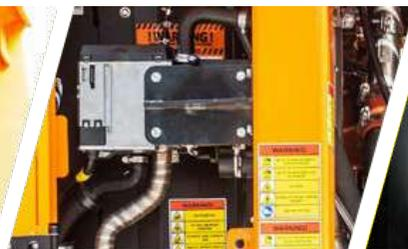
Sistema de pré-aquecimento de óleo do motor e hidráulico .
