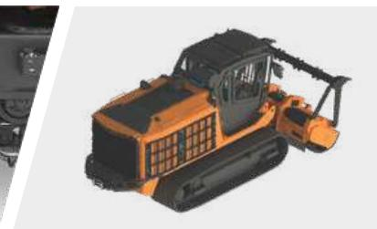
Kit de proteção florestal (grades nas janelas laterais da cabine + protetores de portas e do compartimento do motor)
