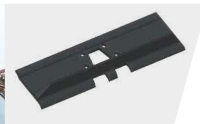
Sapatas de aço de 810 mm com um único dente.
