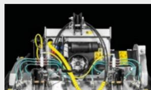
**Sistema de inyección de agua WSS Basic**
