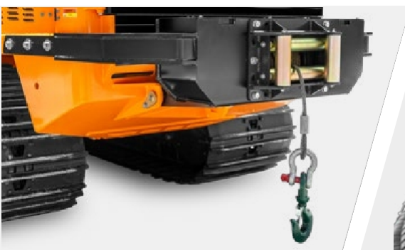
Guincho traseiro com força de tração de 13 t
