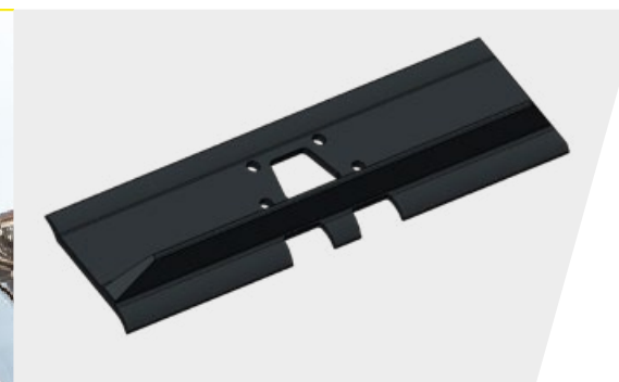
Almofadas de aço de 810 mm com uma única ranhura
